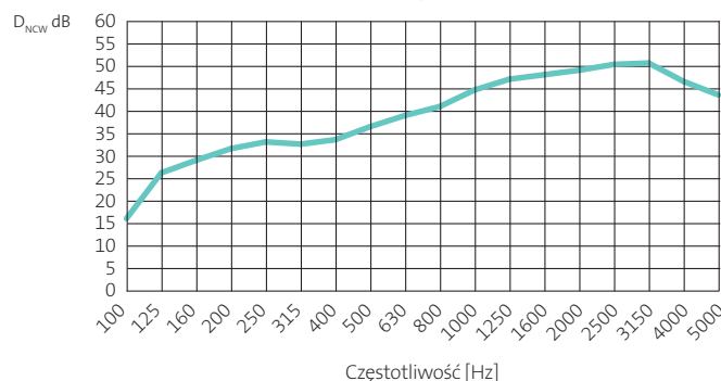
Izolacyjność akustyczna wzdluzna D_{NCW}
